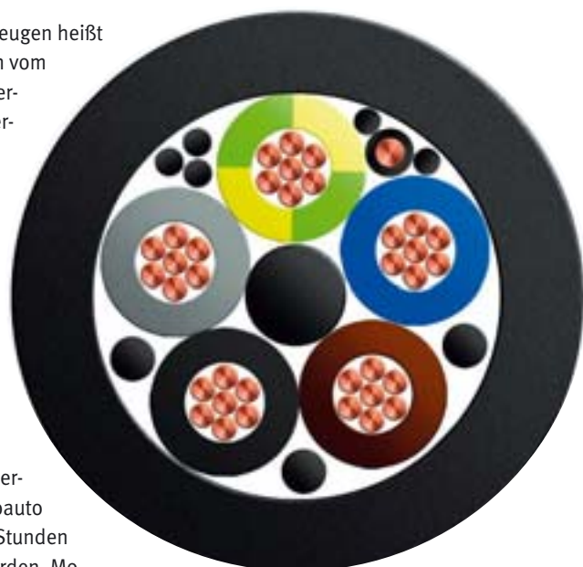
Querschnitt eines 3-phasigen Ladekabels
