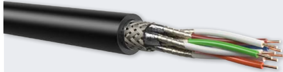
Bild 3: MegaLine® F6-90 S/F CI mit Funktionserhalt von Kategorie 7 nach EN 50289-4-16 über 120 Minuten (PH120 Klassifizierung). Alternative Mantelfarbe z. B. orange auf Anfrage
