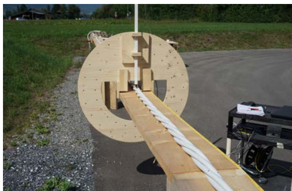
20 Meter langer Messtisch mit Teilungsapparat zur Messung der Magnetfelder im Nah- und Fernbereich.
