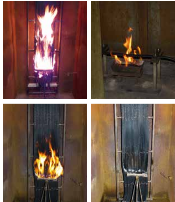
SeaLine® nach EN 50399, Klasse B2 ca mit einer max. Abbrennstrecke von 1,5 m
