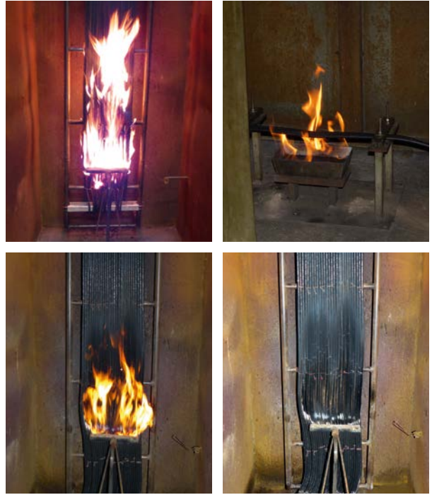
SeaLine® 根据 EN 50399 标准，B2ca 级，最大燃烧长度为 1.5m
